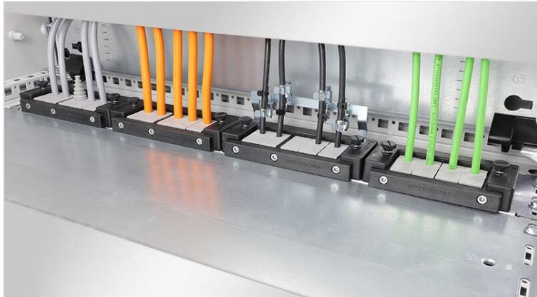
Il KDR-ESR è una piastra brevettata che si installa sul fondo dei quadri per il passaggio dei cavi. Le tasche per l'inserimento a scatto dei listelli [KEL-U](#) e [KEL-QUICK](#) sono già premontate. Dopo aver inserito i cavi nelle strutture KEL-U queste vengono facilmente e velocemente inserite a scatto nelle tasche del KDR-ESR. In caso di manutenzione, i listelli KEL-U vengono rimossi dalle tasche senza l'ausilio di attrezzi.
